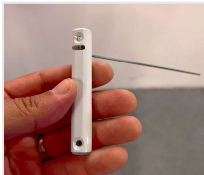
Obr.č.18: Ak ste si zvolili prevedenie siete so samozatváračom, obdržíte ho v príbalovom materiály. Samozatvárač sa dvoma skrutkami skrutkuje o rám dverí do horného rohu na strane pántov.
