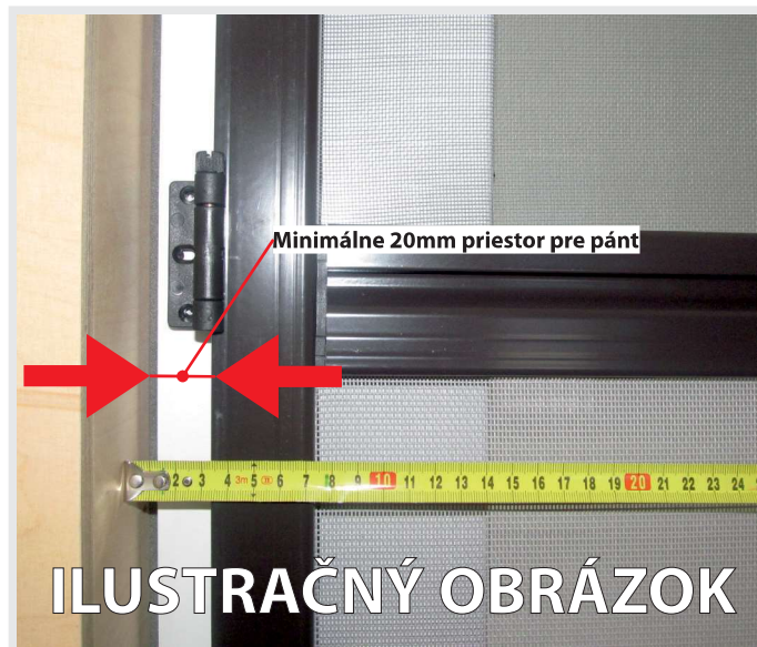
Obr.č.4: Priestor pre pánty. Pri zameriavaní dbáme na to, aby sme mali dostatok miesta pre montáž a funkčnosť pántov. Minimálne to musí byť 20mm od okraja siete.
